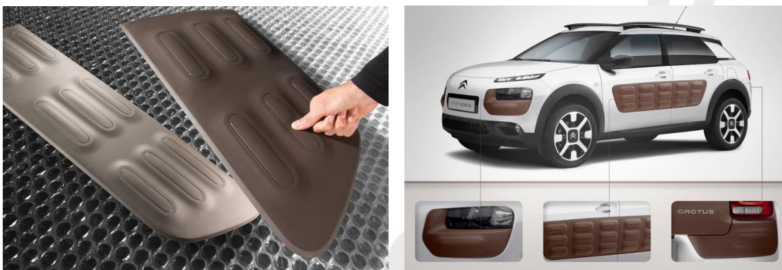
Współpraca firmy Faurecia z BASF w celu zastosowania nowego tworzywa sztucznego, wymagającego nowych sposobów montażu (BGS, 2016)
